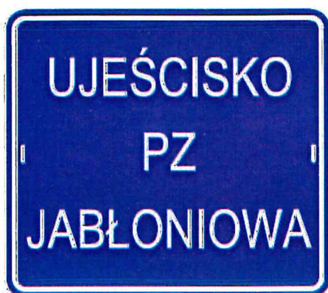
Rys. 15 Wzór tabliczki z oznaczeniem punktu zasilającego
